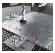
可以切割出几乎任何尺 寸、最接近于成品零件 的产品
